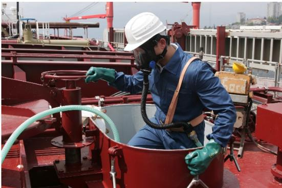
Abbildung 1: Frischluft-Schlauchgerät 6500/ Grundgerät, Action Bild, EKASTU Safety GmbH, zur freien Verwendung
